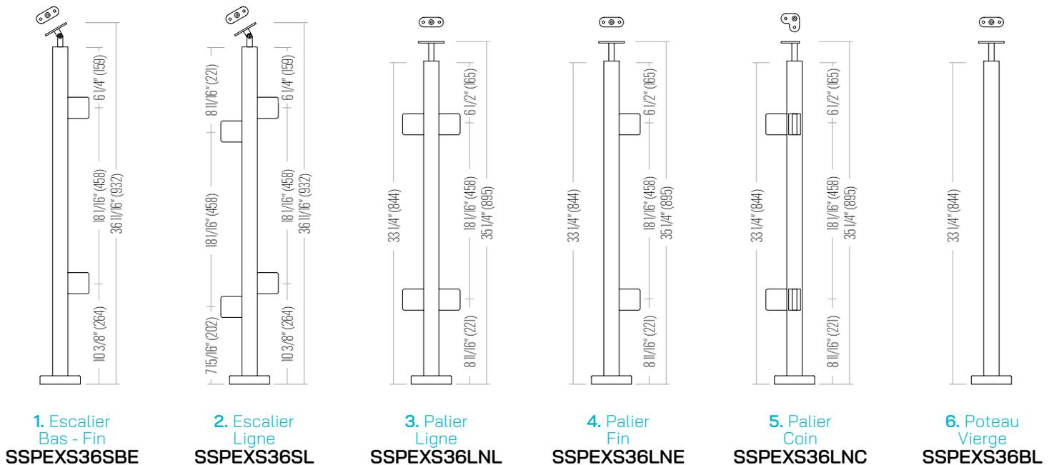
Configurations d'Escalier Typiques pour Poteaux de 36" (914 mm) - 42" (1067 mm)
