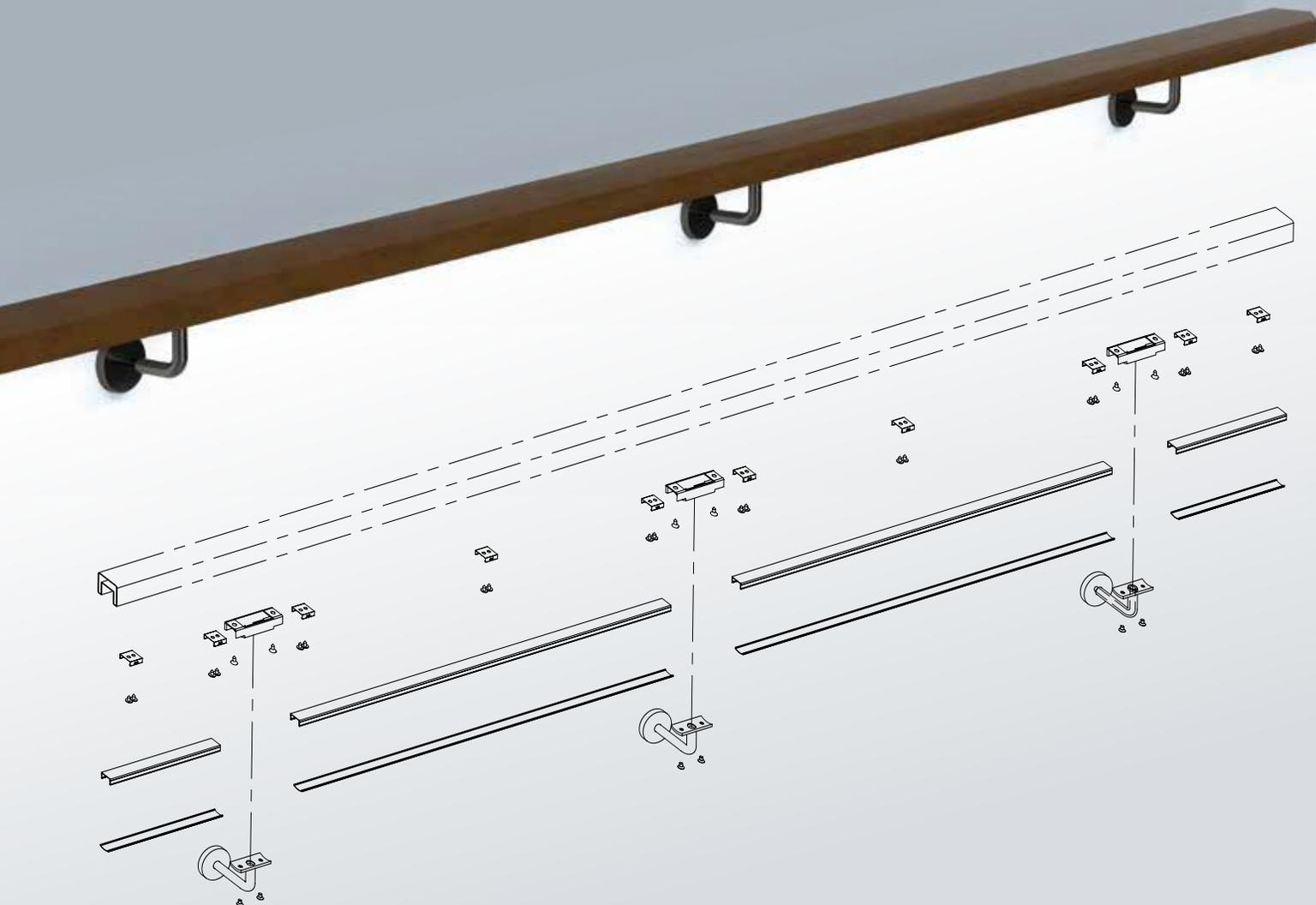
La trousse de matériel s'adapte à tous les profils de main courante avec une fente minimum de 24 x 24 mm.
