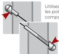
Utilisez des rondelles biseautées pour les poteaux de terminaison d'escalier comportant des trous inclinés. Disponible pour les raccords à borne fileté et Quick-Connect®. Installez toujours le raccord Quick-Connect® dans le montant d'escalier supérieur pour empêcher l'eau de pluie de couler le long du câble dans le raccord.
