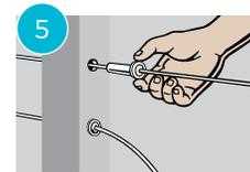
Enfilez l'extrémité libre du câble à travers les poteaux intermédiaires et le poteau d'extrémité Quick-Connect® SS. Faites glisser une rondelle plate et un raccord Quick-Connect® SS jusqu'à ce qu'ils reposent contre la face du poteau. Utilisez une aiguille à lacer si l'accrochage devient un problème.
