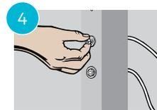
Insérez la borne fileté à travers le poteau d'extrémité et fixez une rondelle plate et une rondelle-écrou Snug-Grip®. Faites tourner l'écrou 2 tours complets. Une forte résistance sera ressentie lorsque les filetages Snug-Grip® s'engageront, alors tenez l'arbre du terminal avec une pince.
