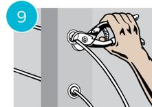
Utilisez un coupe-câble ou une meuleuse électrique avec disque de coupe pour couper l'excédent du câble. Meuler les extrémités exposées du câble avec une meuleuse électrique.
