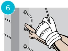
**6** Tendez le raccord Quick-Connect®SS d'une main et tirez fermement sur le câble de l'autre. Le raccord se verrouille automatiquement lorsque vous relâchez le câble.
