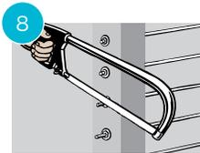
**8** Utilisez une scie à métaux, une scie alternative ou une meuleuse électrique avec disque de coupe pour scier les fils en excès aussi près que possible de la rondelle-écrou Snug-Grip®. Retouchez avec une meuleuse électrique. Les filetages spéciaux Snug-Grip® empêchent le desserrage de l'écrou.
