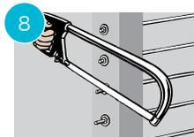
Utilisez une scie à métaux, une scie alternative ou une meuleuse électrique avec disque de coupe pour scier les fils en excès aussi près que possible de la rondelle-écrou Snug-Grip®. Retouchez avec une meuleuse électrique. Les filetages spéciaux Snug-Grip® empêchent le desserrage de l'écrou.
