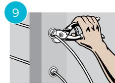
**9** Utilisez un coupe-câble ou une meuleuse électrique avec disque de coupe pour couper l'excédent du câble. Meuler les extrémités exposées du câble avec une meuleuse électrique.
