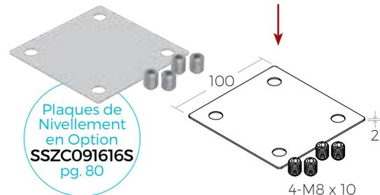
Plaques de Nivellement en Option **SSZC091616S** pg. 80
