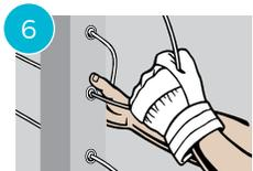
Tenez le raccord Quick-Connect® SS d'une main et tirez fermement sur le câble de l'autre. Le raccord se verrouille automatiquement lorsque vous relâchez le câble.
