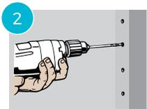
Percez des trous de 5/16" dans un poteau d'extrémité pour le raccord de borne fileté, des trous de 3/8" dans l'autre poteau d'extrémité pour le raccord Quick-Connect® et des trous de 1/4" dans tous les autres poteaux.
