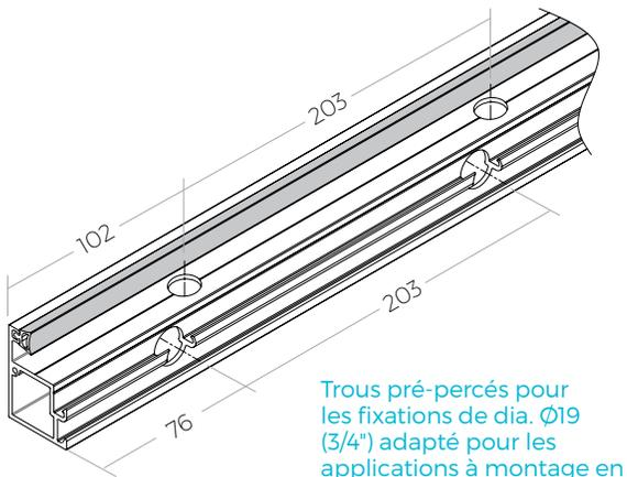
Trous pré-perçés pour les fixations de dia.  $\varnothing 19$  (3/4") adapté pour les applications à montage en surface ou latéral.
