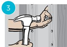
Insérez les manchons de protection aux endroits nécessaires. Tapez jusqu'à ce qu'il affleure.
