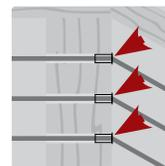
Les manchons protecteurs empêchent l'abrasion au niveau des transitions inclinées sur les poteaux en bois (par exemple, les poteaux de transition d'escalier ou les faces extérieures des poteaux à double coin). Adapter pour des trous de perçage de 1/4" de diamètre.
