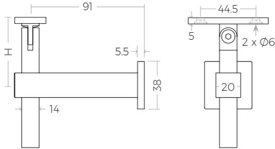
Installé avec un boulon-vis M8
