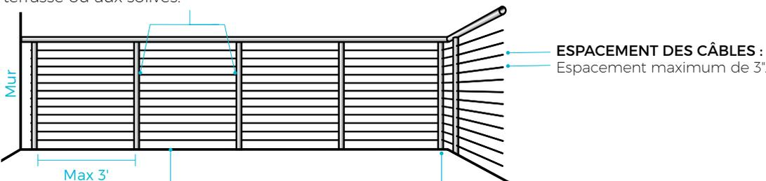
**REPOSE-PIEDS** (en option) : Les rails repose-pieds ne doivent pas être espacés de plus de 4" au-dessus de la surface de la terrasse, ou tel que requis par le code local, et doivent être dimensionnés selon les besoins pour la résistance du support et l'apparence de la conception.
