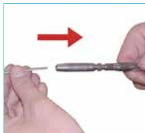
2 Insérez le Câble dans le Raccord.
