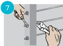
Tendez les câbles en maintenant l'arbre de la borne fileté avec une pince étau et en faisant tourner les rondelles-écrous Snug-Grip® avec une clé. Une jauge de tension Feeney peut être utilisée pour vérifier une tension uniforme.
