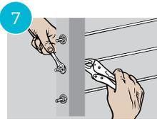
**7** Tendez les câbles en maintenant l'arbre de la borne fileté avec une pince étau et en faisant tourner les rondelles-écrous Snug-Grip® avec une clé. Une jauge de tension Feeney peut être utilisée pour vérifier une tension uniforme.
