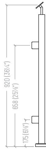
ESCALIER - POTEAU DE FIN - Avant
